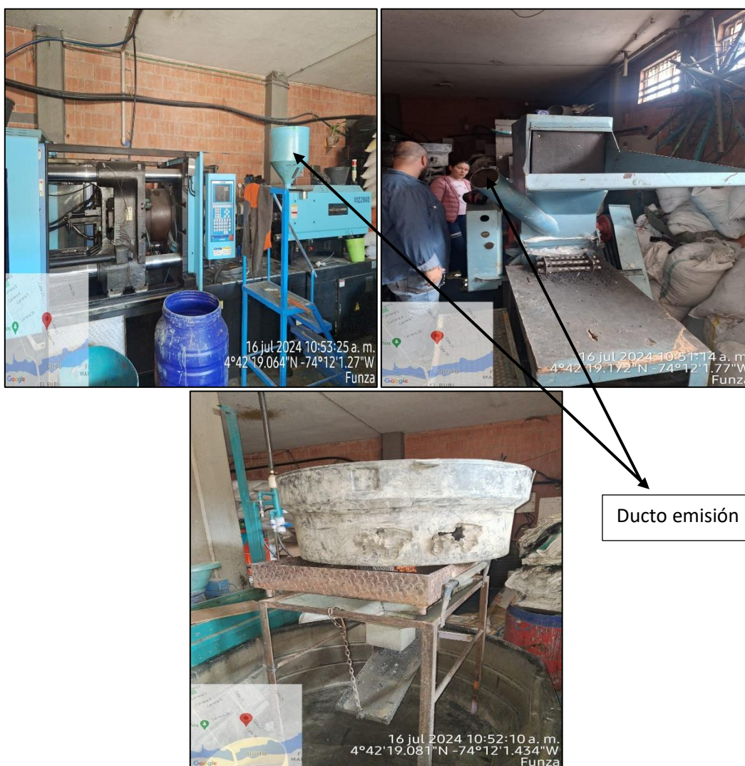
Ilustración 5. Maquinaria utilizada en el triturado de plástico.
